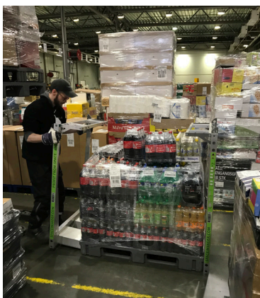
SpacelInvader dobbeltstabler lessede paller
