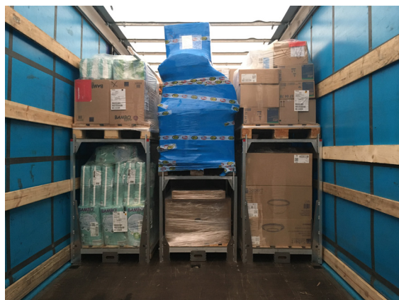
SpaceInvader optimaliserer mange forskjellige godshøyder. Her ses godshøyder på 80cm, 120cm og 160cm
