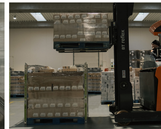
SpaceInvader dobbeltstabler lessede paller som ellers ikke kan stables
